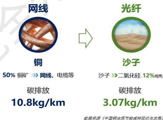
图 2-15 F5G 全光网采用的光纤绿色节能
