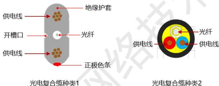
图 5-18 光电复合缆示意图
